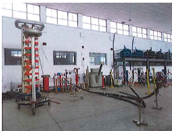
G3: 冲击电压试验 Impulse voltage test
