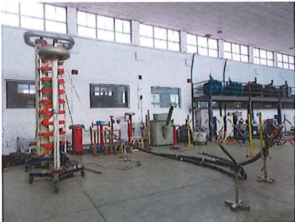
G3: 冲击电压试验 Impulse voltage test
