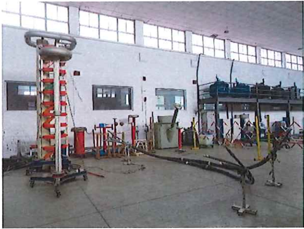
G3: 冲击电压试验 Impulse voltage test
